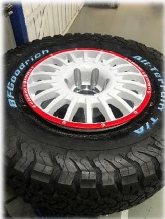
2. Seguidamente puede montarse el neumático de la forma habitual. Una vez inflado el neumático a presión superior a la normal, atornillar los tornillos con final cónico hasta hacer tope contra la llanta
