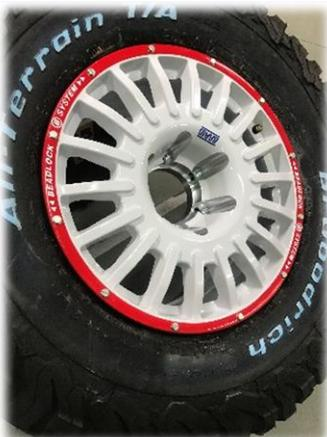
3. Solo después de haber atornillado todos los tornillos proceder a restablecer la presión normal de utilización del neumático
