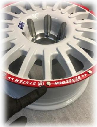
1. Para montar el neumático, deben extraerse previamente todos los tornillos con final cónico
